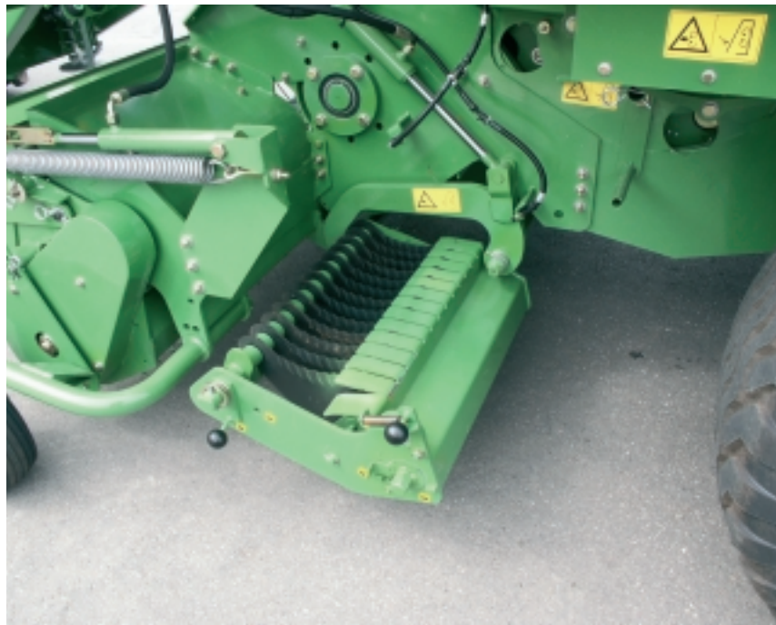
Bild 1: Das Herausnehmen der Messer aus der Schneidwerksschublade ist auch unter beengten Platzverhältnissen gut möglich.
